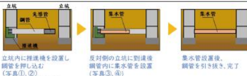
③ 鋼管が反対側へ到達
