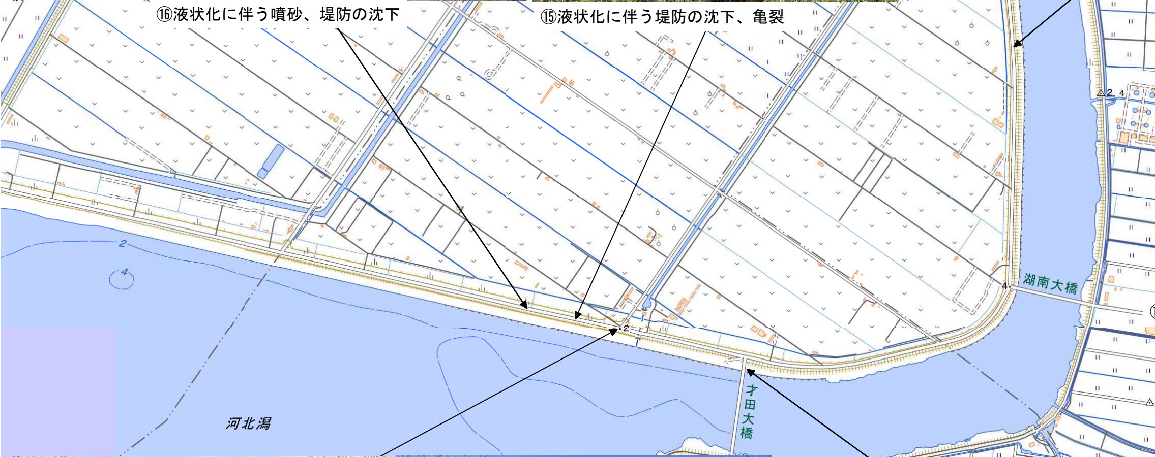
⑫東部承水路沿いの液状化被害：堤防沈下のため嵩上げ
